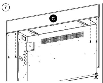
Install the top panel by installing 4 screws. Installez le panneau supérieur en installant 4 vis.
