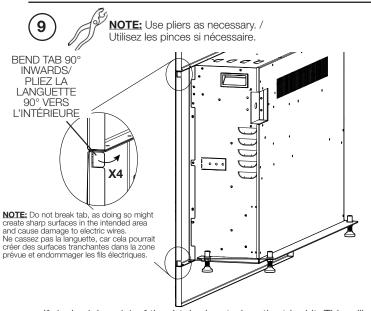
If desired, bend 1 of the 4 tabs located on the trim kit. This will facilitate plugging in the appliance power cord. Si désiré, pliez 1 des 4 languettes situées sur le kit de garniture. Cela facilitera le branchement du cordon d'alimentation de l'appareil.
