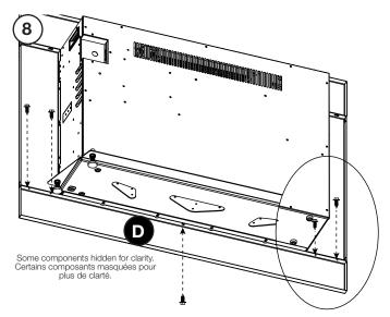
Install the bottom panel by installing 5 screws. Installez le panneau inférieur en installant 5 vis.
